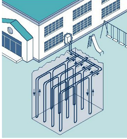
Şekil 3.66 Paint Lick İlköğretim Okulu'nda uygulanan jeotermal ısı pompaları [13]
