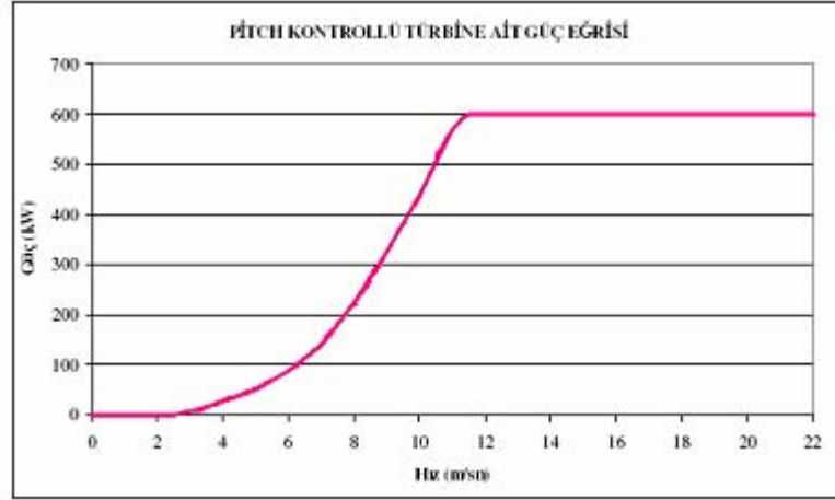
Şekil 2.5 600 Kw Pitch kontrollü türbine ait güç eğrisi [11]
