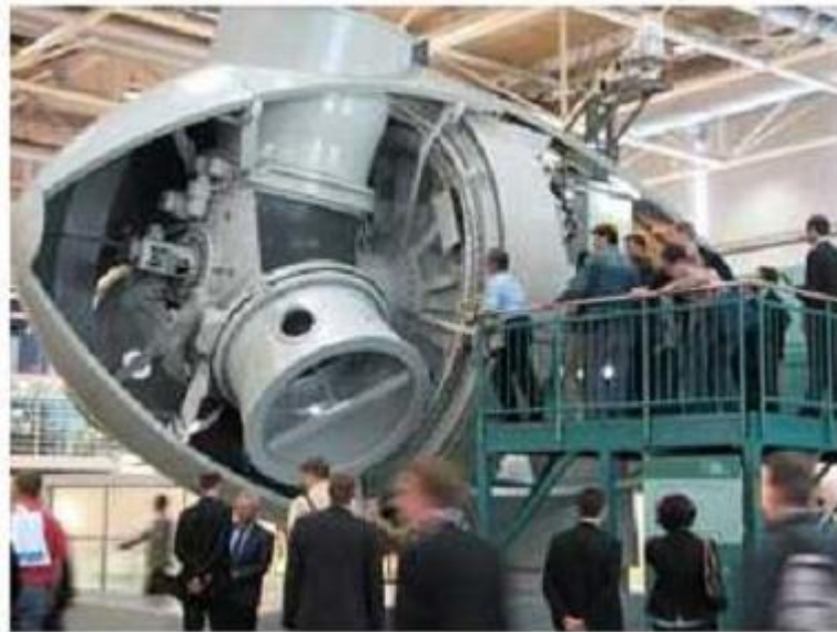
Şekil 3.2 Modern bir Rotor göbeğinin iç yapısı
