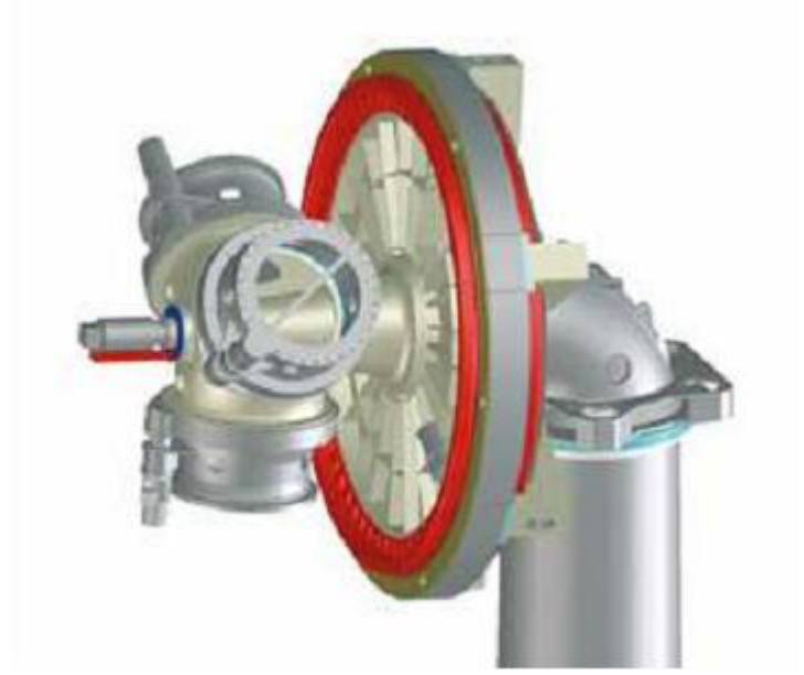
Şekil 3.3 Direct drive sistemi
