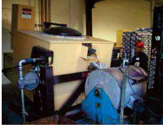
Şekil 2. 14 Gaz ateşlemeli pota fırını
