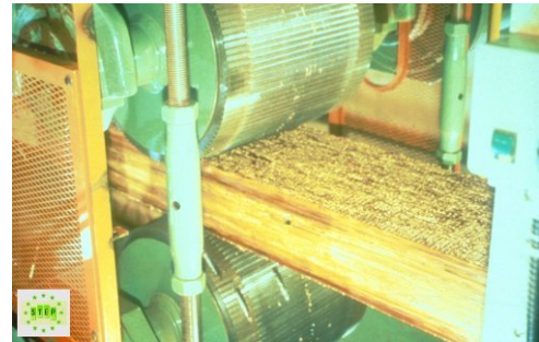
Şekil 4.28 PSL şeritlerinin kesilmesi ve şekillendirilip preslenmesi [97].
