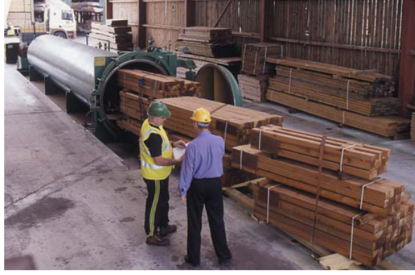
Şekil 3.9 Basınçlı emprenye uygulamasına hazırlanmış keresteler [61].
