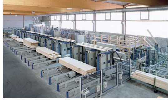
Şekil 2.11 Makineli görsel dereceleme uygulaması [30].
