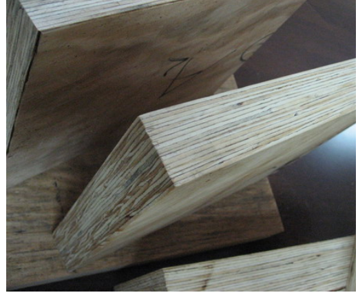
Şekil 4.18 LVL elemanın en kesit görünümü [81].
