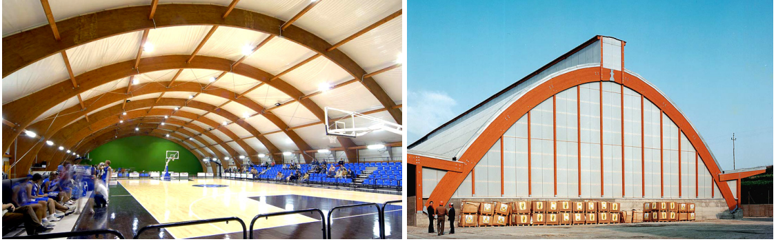
Şekil 5.9 İki ve üç mafsallı dolu gövdeli kemer örnekleri [117].
