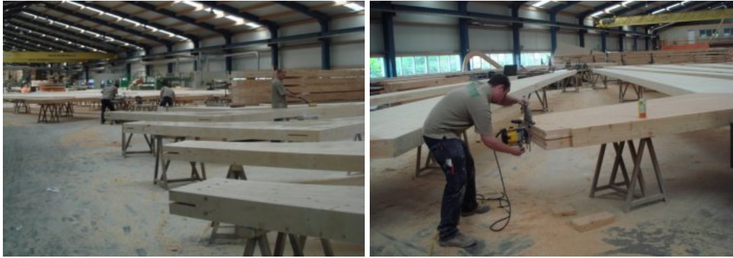
Şekil 3.8 Kesme-delme işlemi yapılan elemanlar ayrı ayrı depolanır [50].
