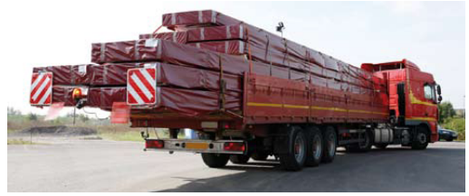
Şekil 3.13 Düz kompozit ahşap elemanların karayolu ile taşınması [62].
