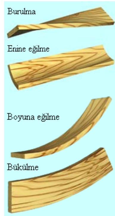
Şekil 2.9 Ahşapta yüzeysel büzülmenin farklı durumları [27].
