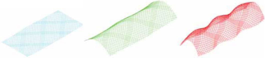
Şekil 5.25 Bir çift tabakalı çift eğrilikli sistemin bilgisayar ortamında oluşturulması [145].
