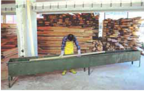
Şekil 3.10 Daldırma ile emprenye uygulanması [61].
