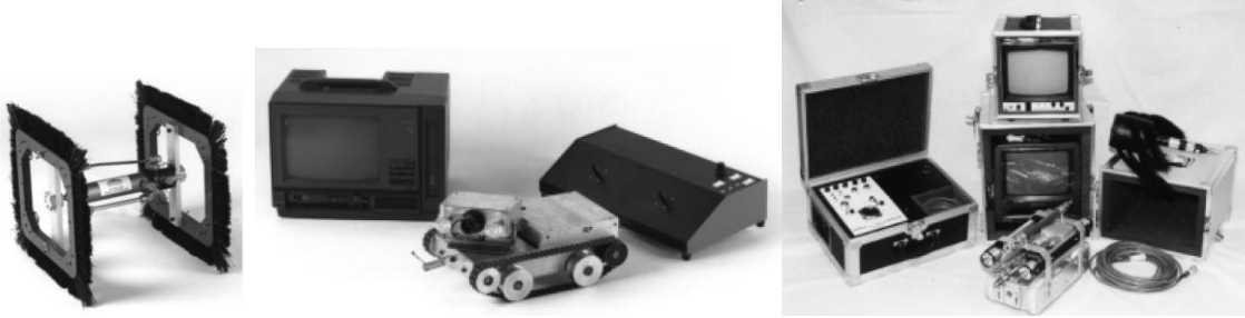
Şekil 5. 2 Kanal temizliğinde kullanılan hareketli fırça, robot sistemi, vakum sistemi ve görüntü kayıt sistemi [6]
