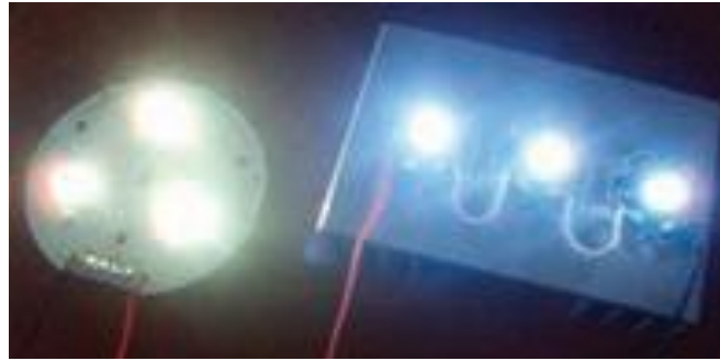
Şekil 4.18 Power LED’li Işık Kaynağı [56]
