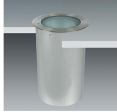
CB90 yere gömme armatür, drenaj çerçevesi, düz şeffaf camlı, 1x HIT 150W, paslanmaz çelik, koruma sınıfı IP67 olan, topraklama sınıfı 1
