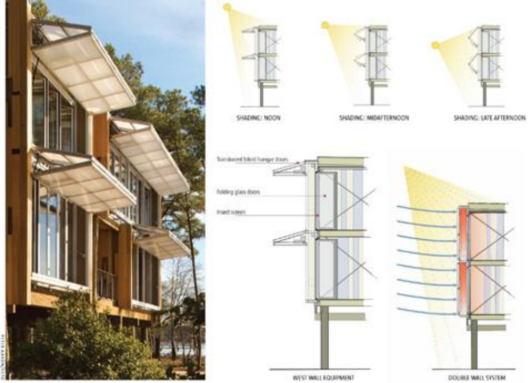
Şekil 3.32. Katlanarak güneşlik olan doğu duvarı ve şematik kesitleri [21]
