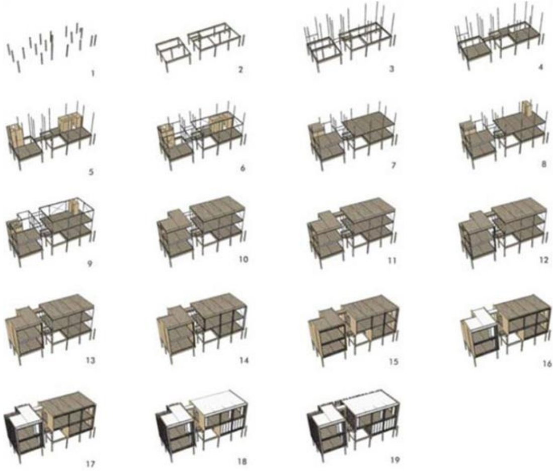
Şekil 3.37 Loblolly Evi, montaj – demontaj aşamaları şeması [21]
