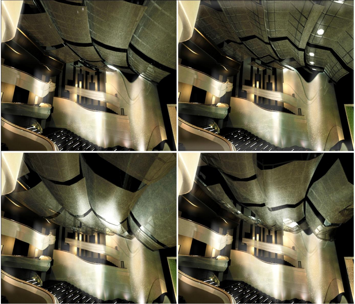
Şekil 5.20 Akustik tavanın AMS-s ile form değiştirmesi.
