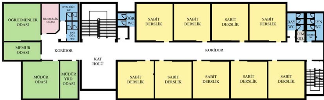
Şekil 5.24 Revize 10025R-720 Tip İlköğretim Okulu Projesi Birinci Kat Planı
