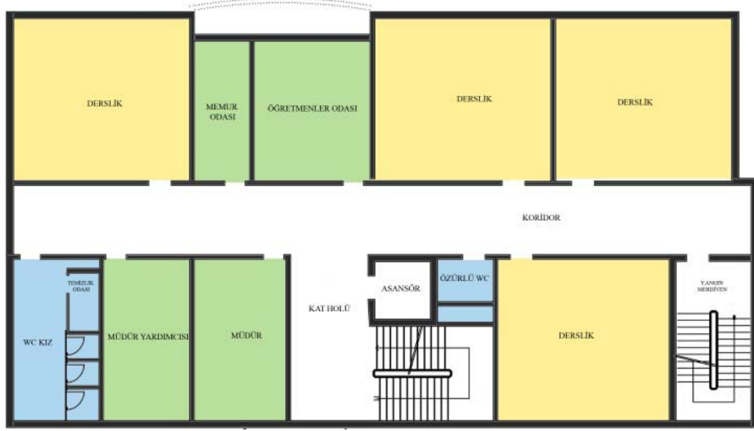
Şekil 5.9 Revize 2000-41 Tip İlköğretim Okulu Projesi Birinci Kat Planı
