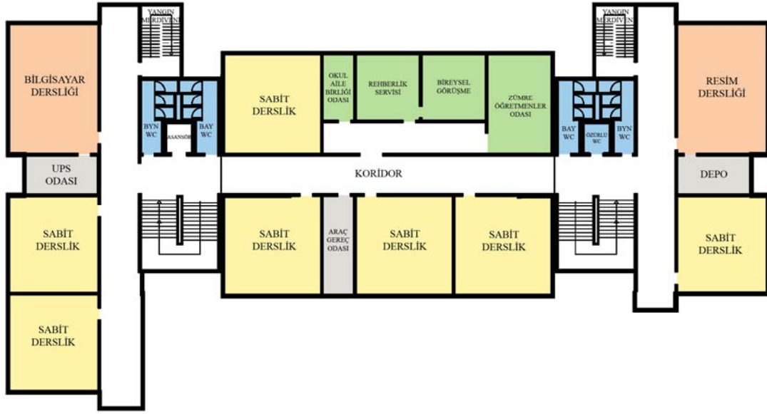
Şekil 5.36 Revize MEB 2000-42 Tip İlköğretim Okulu Projesi İkinci Kat Planı
