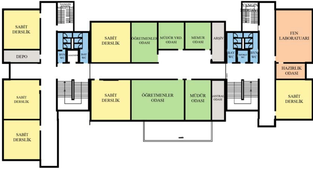
Şekil 5.34 Revize MEB 2000-42 Tip İlköğretim Okulu Projesi Birinci Kat Planı
