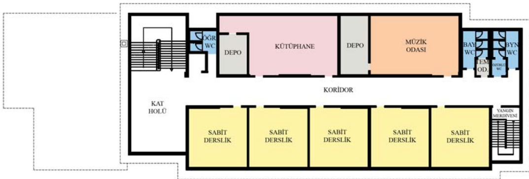
Şekil 5.28 Revize 10025R-720 Tip İlköğretim Okulu Projesi Üçüncü Kat Planı
