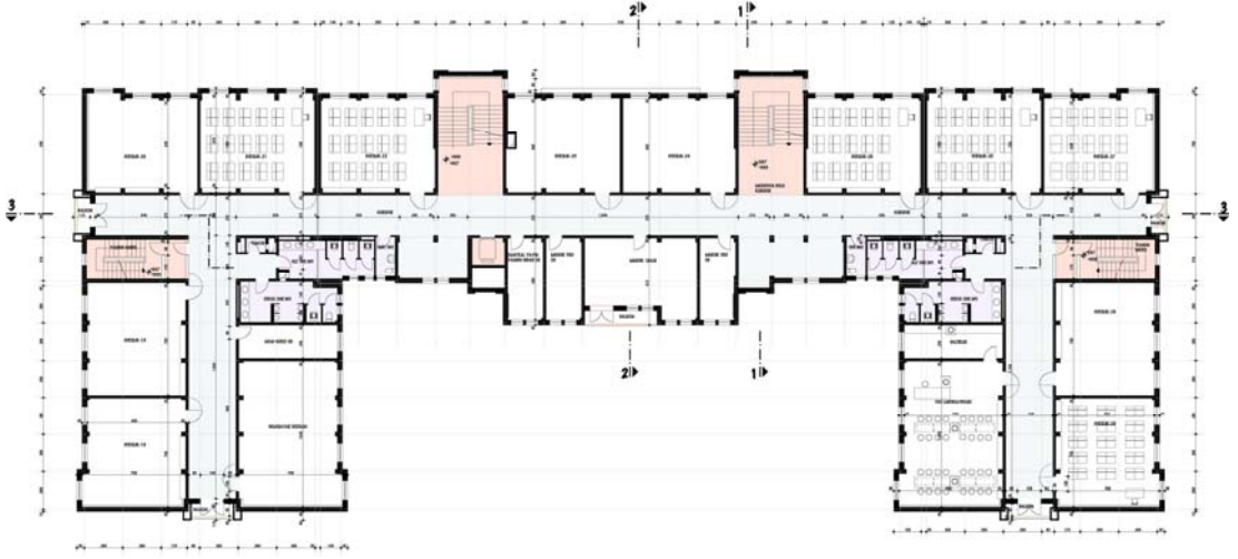
Şekil 5.42 MEB 2004-53 Tip İlköğretim Okulu Projesi İkinci Kat Planı
