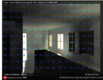
Şekil 4.9 Doğal Aydınlatma Analizinde Autodesk Revit ve 3ds Max Programlarının Kullanımı [19]
