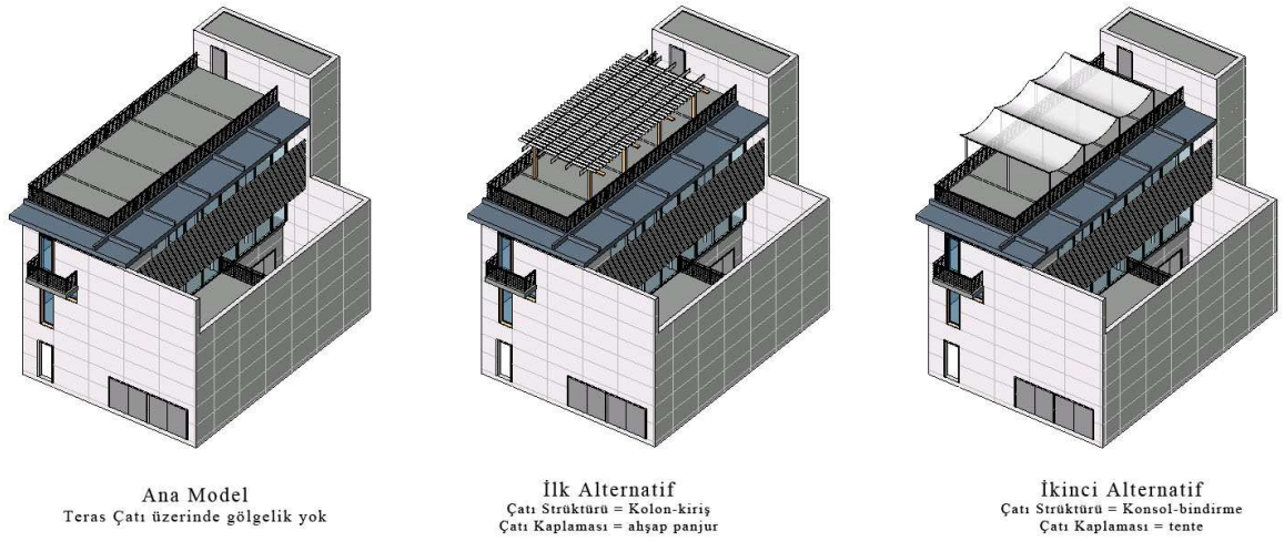
Şekil 4.5 Revit’te aynı model üzerinde tasarım alternatifi uygulaması
