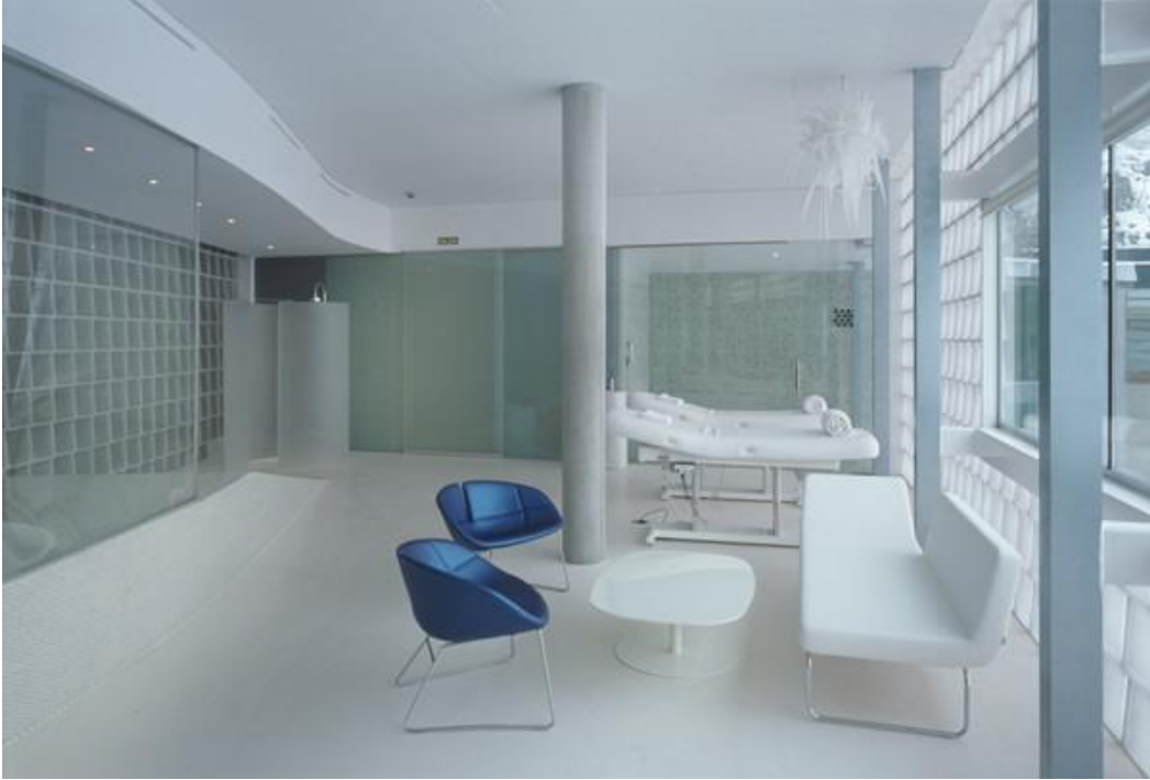
Şekil 5.90 Termas de Tiberio. İç Mekandan Görünüm. Gün ışığından yararlanmak için duvarlarda cam tuğla kullanılmış. ( http://www.moneobrock.com/Panticosadwgs.htm )
