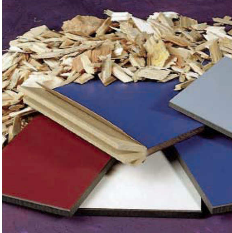
Şekil 3.1 Kompakt laminat levhalar ile ana madde olan kraft kâğıdı ve talaş [4]
