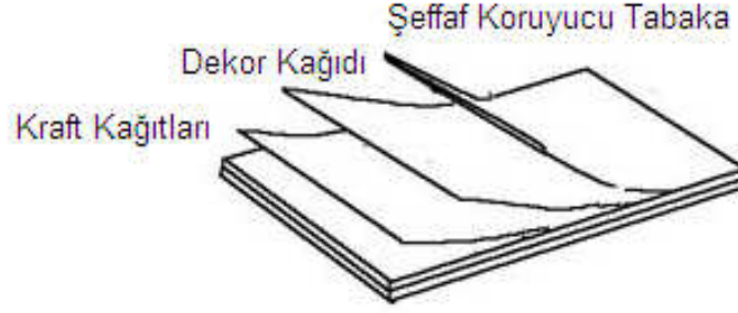
Şekil:3.4 Kompakt Laminatın Katmanları [1]
