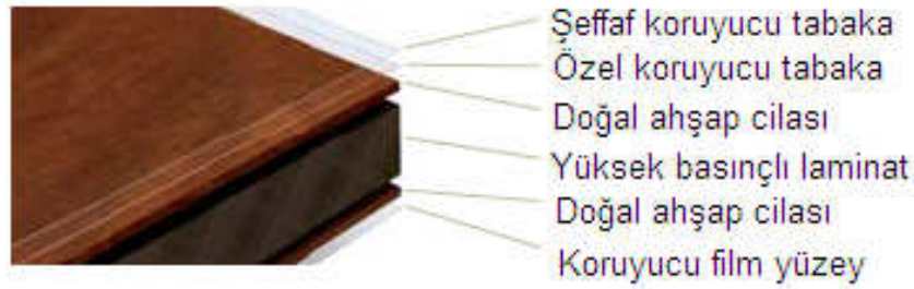
Şekil 3.5 Yeni geliştirilen farklı özellikteki yüksek basınçlı laminat [5]
