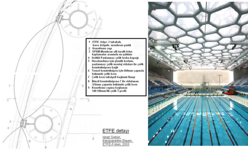
Şekil 4.21 Watercube cephesinden alınan bir ETFE yüzey detayı [41-43].
