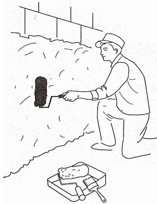
Şekil 5.23 Su yalıtım malzemesinin uygulanması (Williams, 1993b)
