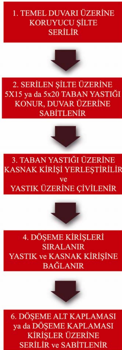
Şekil 7.2 Döşemenin uygulanmasına yönelik süreç (Allen, 1999)
