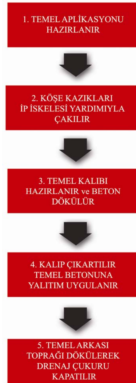
Şekil 7.1 Betonarme temelin uygulanmasına yönelik süreç (Allen, 1999)
