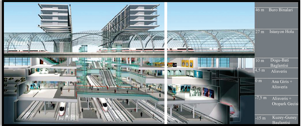
Şekil 4.40 Berlin Merkez Tren Garı'nın kesiti (Anonim, 2005.5)
