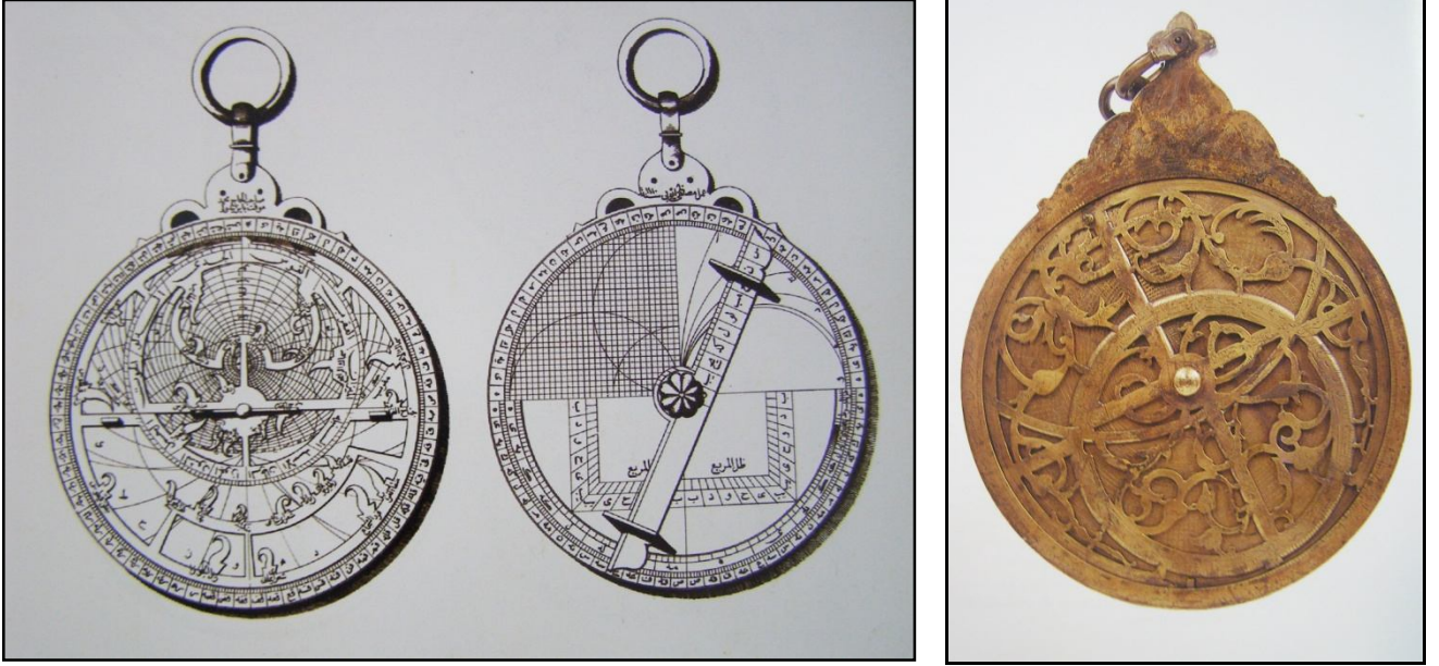
Resim 3.5-6 Bir usturlabın ön ve arka çizimleri (Özdemir, 1993)
