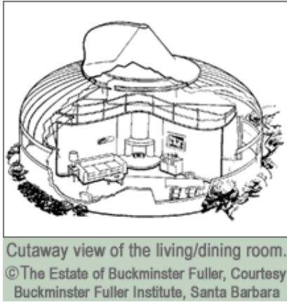
Şekil 4.9 Dymaxion evi kesiti ve Dymaxion yerleşim ünitesi
