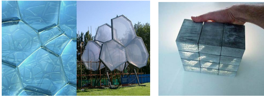
Şekil 4.1 Tekzel®ETFE fluoropolymer resin ve yarısaydam beton litrocon ( www. isuhangat.blogspot.com , www.soundofcity.com )
