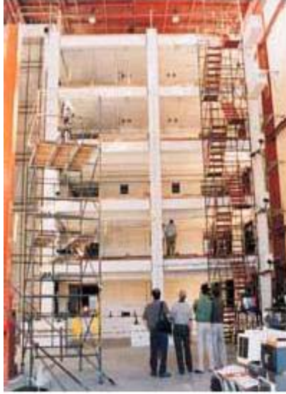
Şekil 5.9 Sismik testler uygulanmak üzere inşa edilmiş % 60 ölçekli 5 katlı model (UCSD, University of California, San Diego ) (Priestley vd., 1999)
