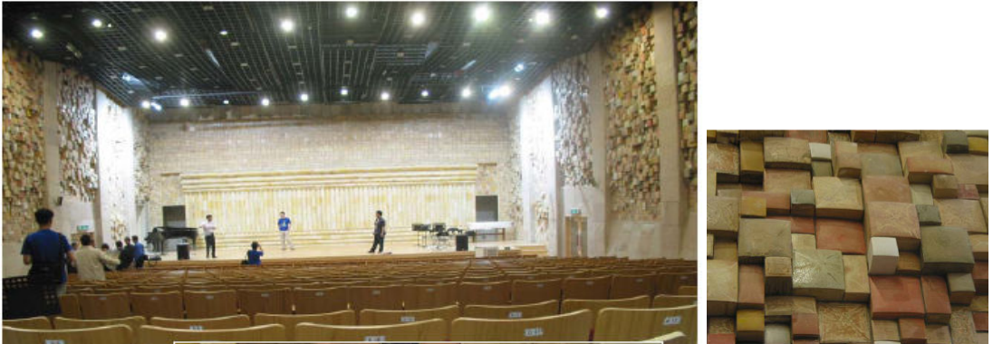
Şekil Ek3.6 QRD dağıtıcıların bir hacimde uygulanması (Rindel,2004)
