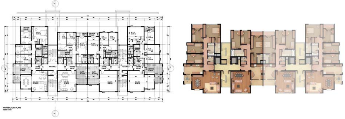
Şekil 2.7 Aynı kat planının avan proje çizimi ile bu çizimin renklendirme ve gölgelendirme teknikleri ile daha kolay okunur hale getirilmiş anlatım şekli. (Min Tasarım arşivi)
