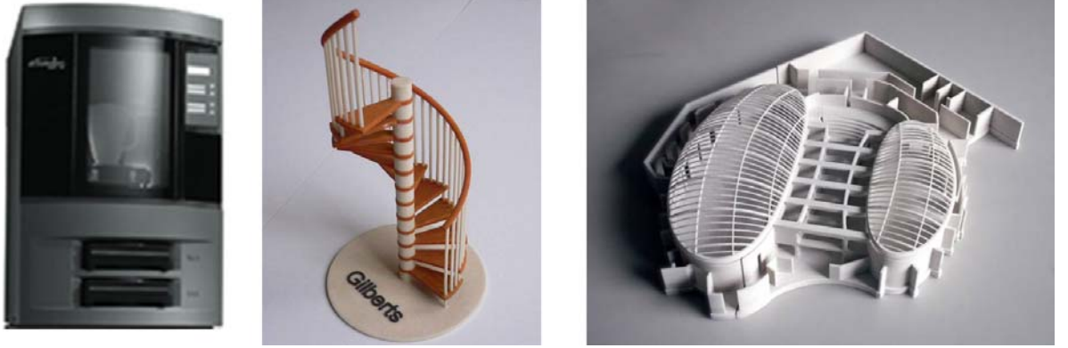
Şekil 2.29 3D printer olarak da adlandırılan bir LOM makinesi örneği [16] ve bu türden bir makine ile üretilmiş obje örnekleri [17].
