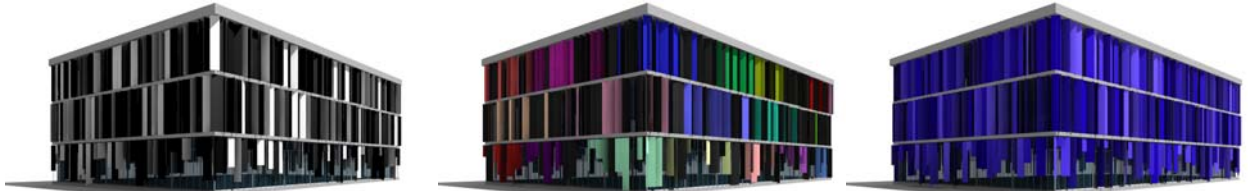
Şekil 2.2 Bilgisayar ortamında parametrik modelleme yöntemi ile tasarlanan cephe sistemi farklı alternatiflerin kolaylıkla denenebilmesine olanak sağlar. (Alper Gürtekin, 2006)
