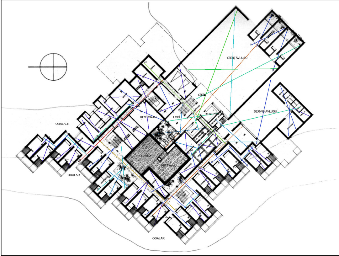
Şekil 4.21: Vaziyet Plânı Üzerinde Axial Doğru Haritası (Hotel Les Gorges du Dadès / Boumalne / Fas)
