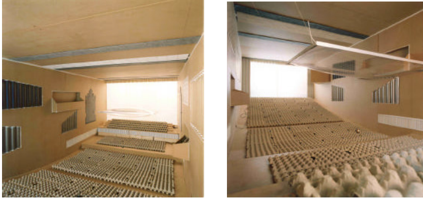
Şekil 4.58 Yumurta kutuları ile yapılan akustik deneme modelleri.
