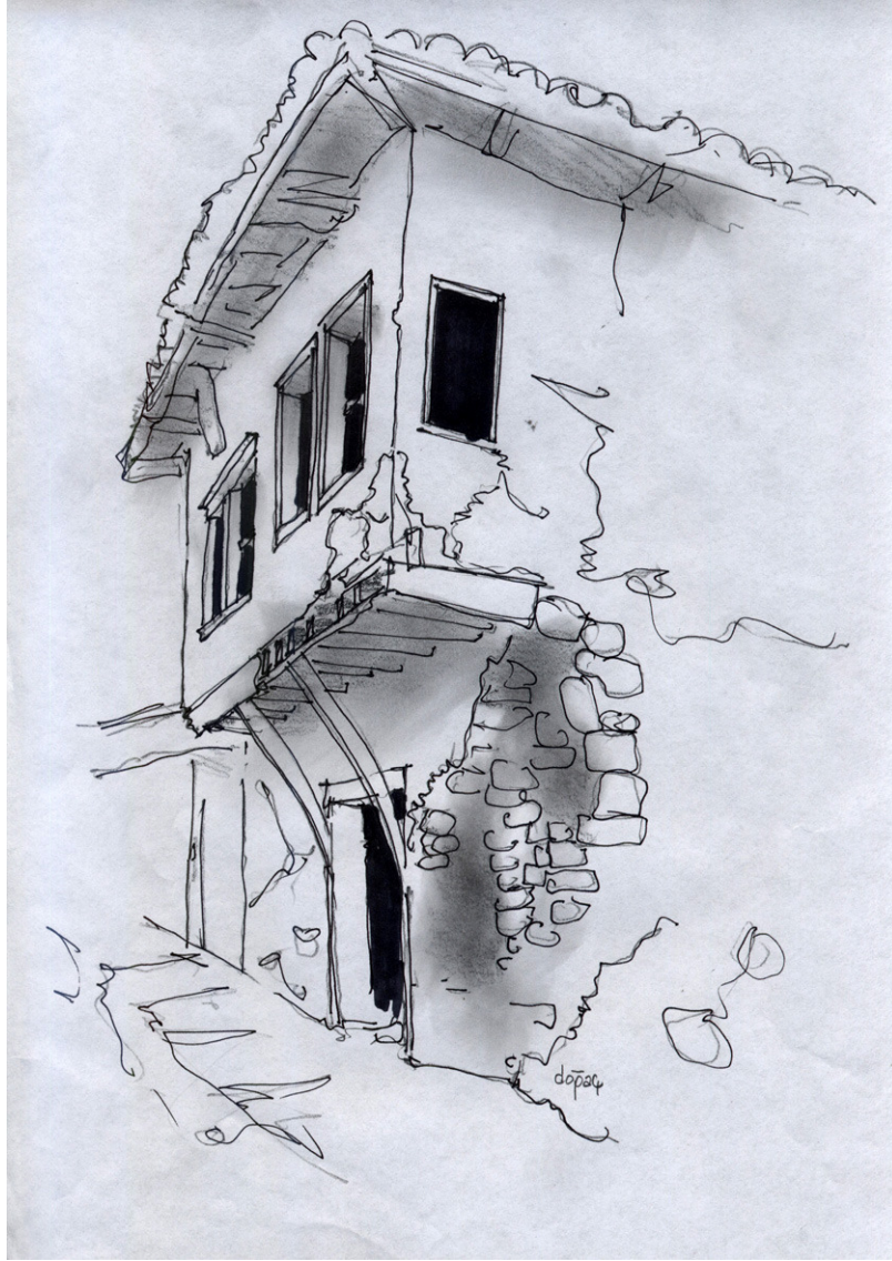
Resim 2.1 Zemin katı kerpiç yığma, üst katı hımış yapım sistemiyle yapılmış bir ev
