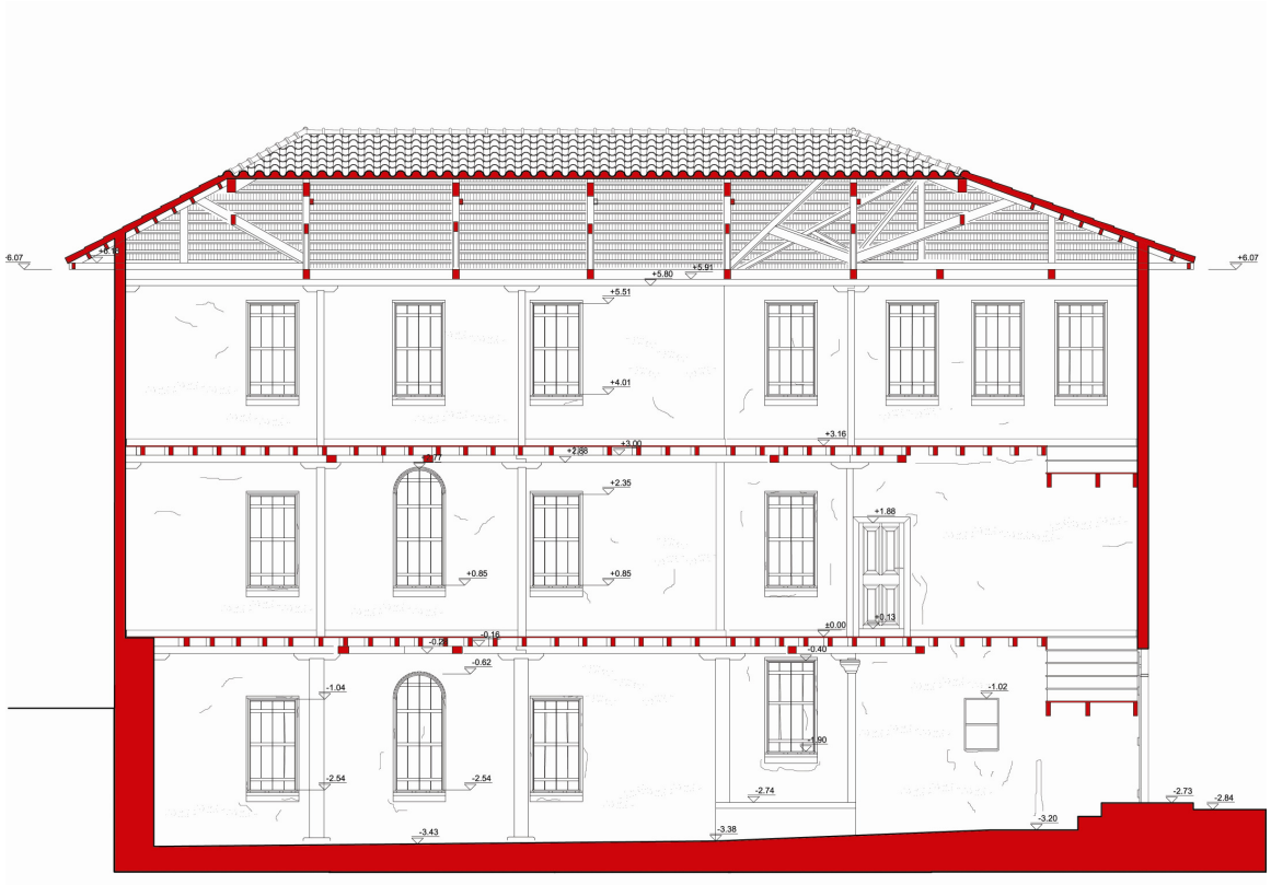
Şekil 3.28 Mehmet Özden Evi çatı konstrüksiyonu ve kesiti
