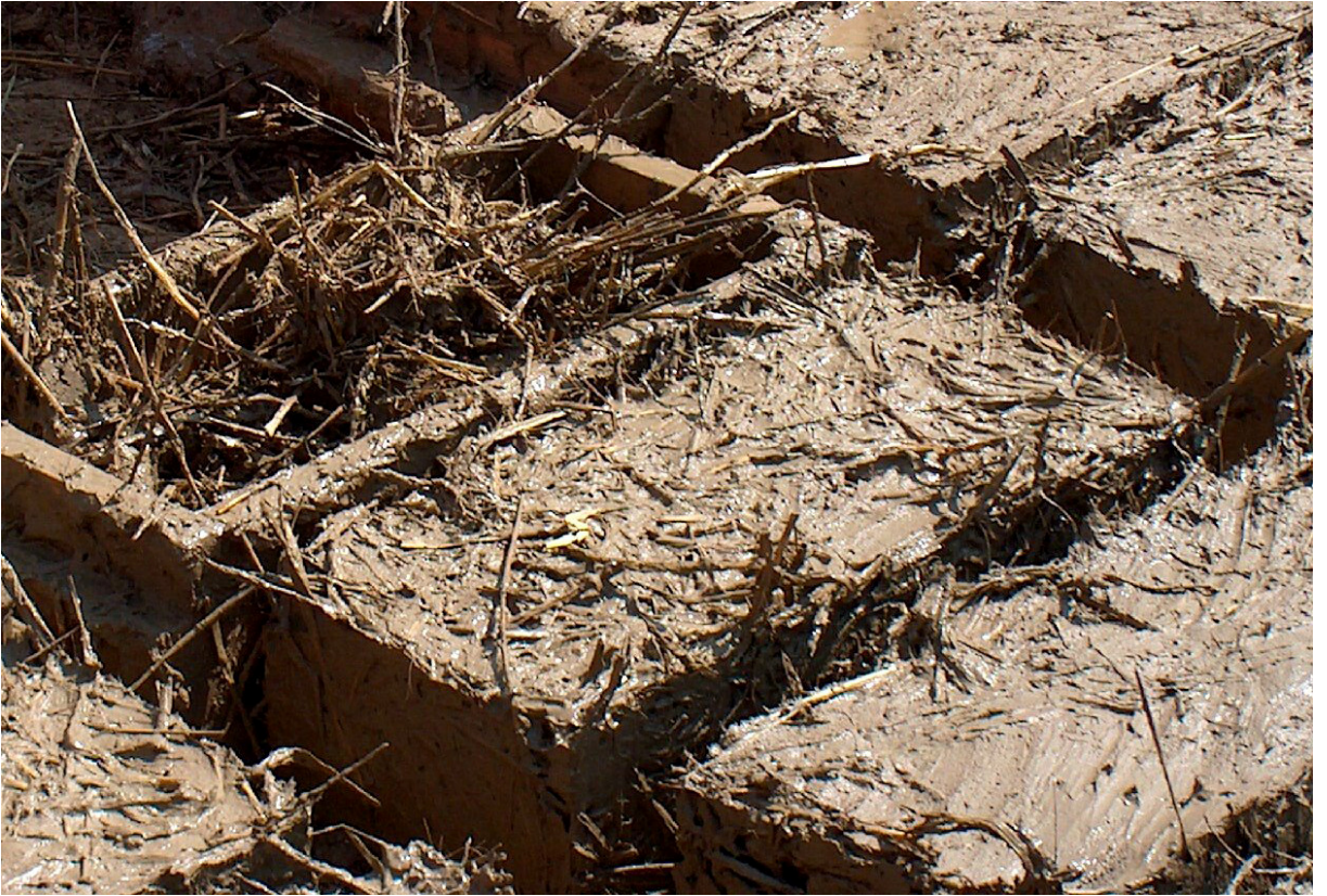
Resim 2.9 Kerpiç kalıbına yeni dökülmüş karışım [1]
