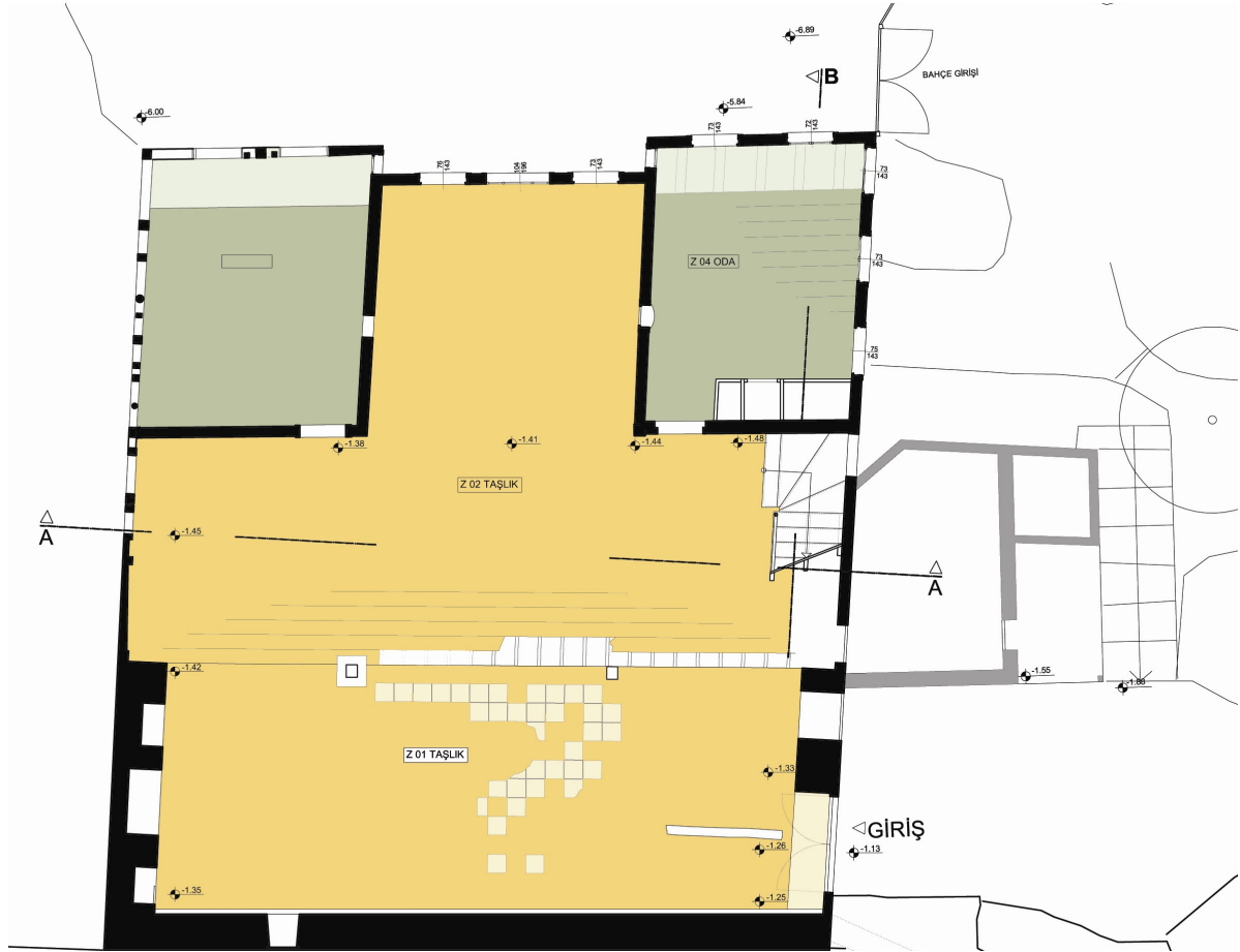
Şekil 3.15 Ellezler konağı zemin kat planı (Rölöve)
