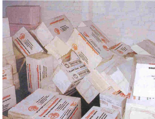
Şekil 3.56 Hatalı bir depolama [24]
