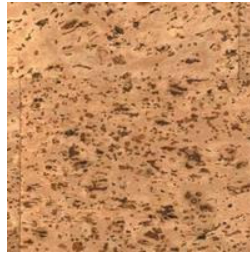
Şekil 4.47 Genleştirilmiş mantar levhaların dokusu [55]
