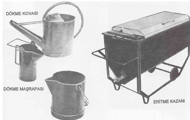
Şekil 4.17 Sıcak bitüm karışımının oluşturulmasında ve dökülmesinde kullanılan araçlar (Toydemir vd., 2000)
