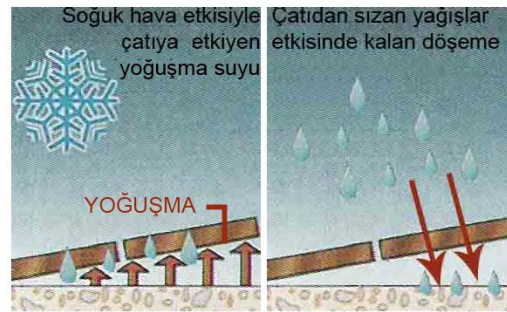
Şekil 2.7 Isıl değişimler ve çatıya etkisi (Saint-Gobain Weber Markem YKS, 2006)
