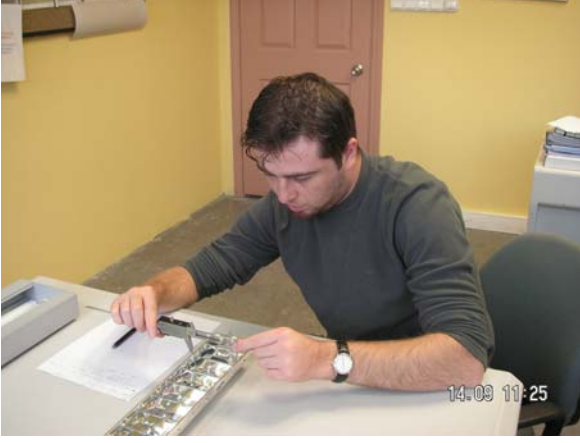
Resim 12.5 Aydınlatma aygıtı yansıtıcısının verilere uygunluğunun kontrolü
