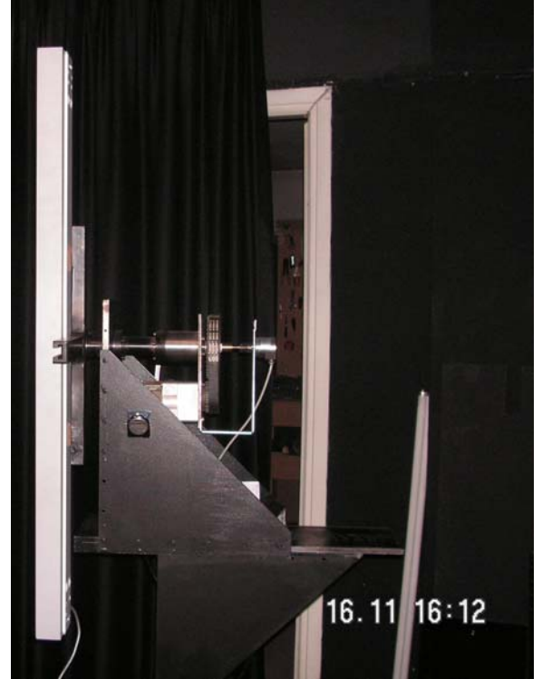
Resim 12.8 Ölçmelerin yapıldığı gonyofotometre (açılı ışıkölçer)
