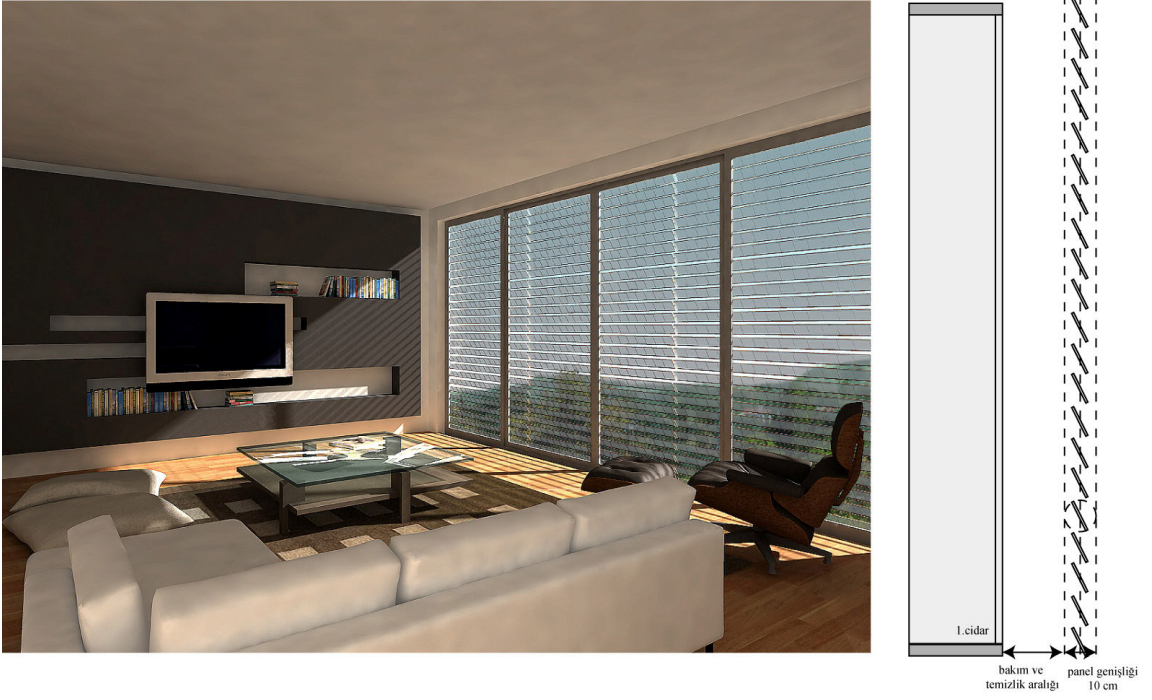
Şekil 3.21 15cm x 15cm ara panel boyutları iç mekan etkisi ve kesiti
