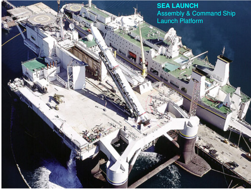
Şekil 5.3.1 Görevden çıkarılarak fırlatma rampasına dönüştürülmüş bir petrol kulesi
