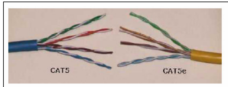
Şekil 4.10 Cat 5 ve cat5 e kabloların karşılaştırılması
