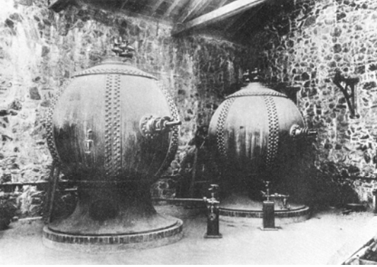
Şekil 4-18 Mum hamurunun hazırlandığı bakır otoklav makinesi Küçükerman, 1988, Beykoz Fabrikası, s.105
