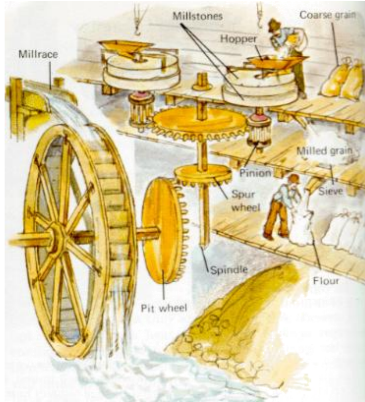
Şekil 5.4 Dişli düzenekleri ile çalışan bir su değirmeninin çalışma prensibini gösteren bir çizim (Hazen, 2000)
