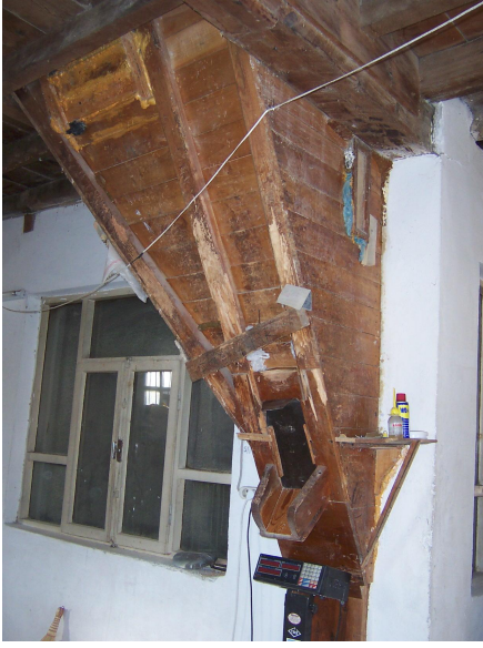
Foto Ek 1.271 Şamlılar Çeltik Fabrikası, 1-02 Paketleme+Depo mekanı, ikinci katta bulunan ambarın tartı üzerine açılan ağız, Nisan 2004
