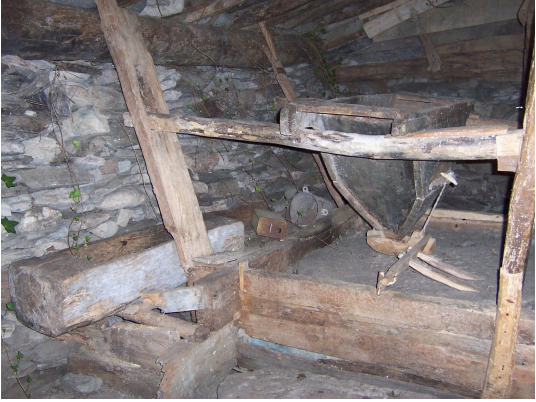
Foto Ek 1.70 Gazidere Tabaklısı, Ahmet Bican Değirmeni, çakıldaklar, buğday teknesi ve arkasında hak alma oluğu, Ekim 2003
