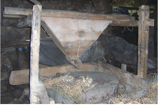
Foto Ek 1.105 Ekinören Köyü, Koca Mehmet'in Değirmeni (Şerafettin Gökçe Değirmeni), çakıldakları sökülmüş değirmen düzeneği, Temmuz 2005
