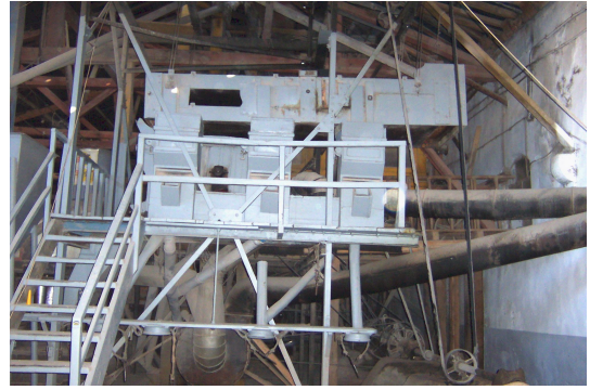
Foto Ek 1.152 Tosya, Bektaş Çeltik Fabrikası, eleklerin altındaki ağızlardan boşalan kırık ve iri pirinç taneleri ayrı çuvallanır, Kasım 2005
