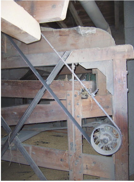
Foto Ek 1.264 Şamlılar Çeltik Fabrikası, 1-03 Üretim mahalli içinde bir elek makinesinin yan görünüşü, Nisan 2004
