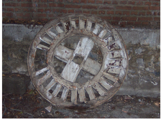
Foto Ek 1.45 Boyabat, Şamlıların Değirmeni, sökülmüş bir su çarkının üst yüzeyi, Eylül 2004
