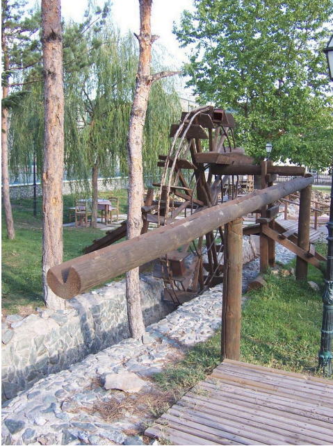
Foto Ek 1.129 Kastamonu Mimar Vedat Tek Anı ve Restorasyon Merkezi, bir su dolabı örneği, çarkın kaldırdığı suyu taşıyan ahşap oluk, Ekim 2003
