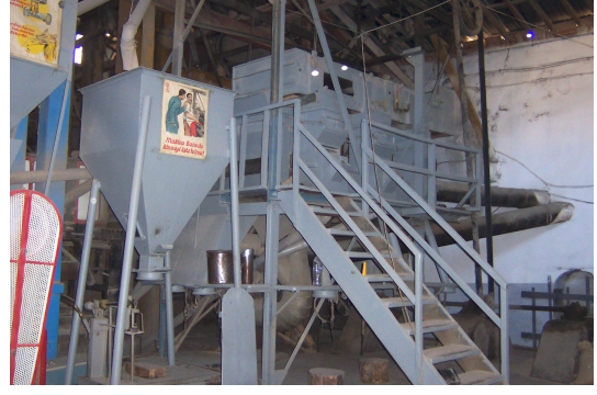
Foto Ek 1.151 Tosya, Bektaş Çeltik Fabrikası, son işlem olarak kırık ve iri pirinç tanelerinin ayrıldığı elek bölümü, Kasım 2005
