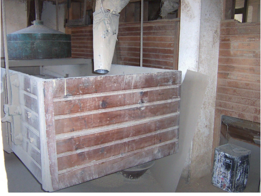
Foto Ek 1.267 Şamlılar Çeltik Fabrikası, 1-03 Üretim 2 mahalli içinde “triyör” (ayırıcı) ve arkasında parlatma taşlarına bağlanan ambar, Nisan 2004
