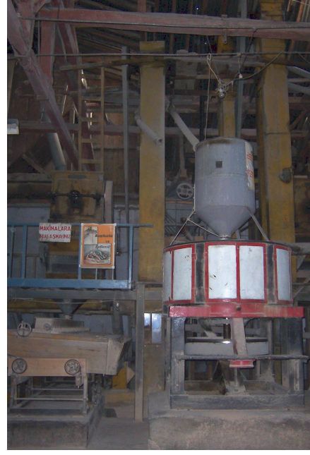
Foto Ek 1.147 Tosya, Bektaş Çeltik Fabrikası, padinlerden sonra gelen parlatma taşı, Kasım 2005
