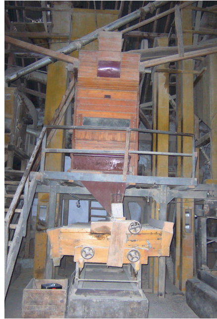
Foto Ek 1.144 Tosya, Bektaş Çeltik Fabrikası, elekten sonra gelen kılçık ayıklama makinesi/padin, Kasım 2005
