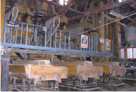
Foto Ek 1.146 Tosya, Bektaş Çeltik Fabrikası, soyucu taşlar ve kabuk aspiratöründen sonra gelen depo ve padinler, Kasım 2005
