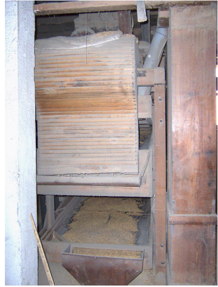
Foto Ek 1.266 Şamlılar Çeltik Fabrikası, 1-03 Üretim mahalli içinde bir elek makinesinin galeri yönündeki ürünü boşalttığı hunisi, Nisan 2004
