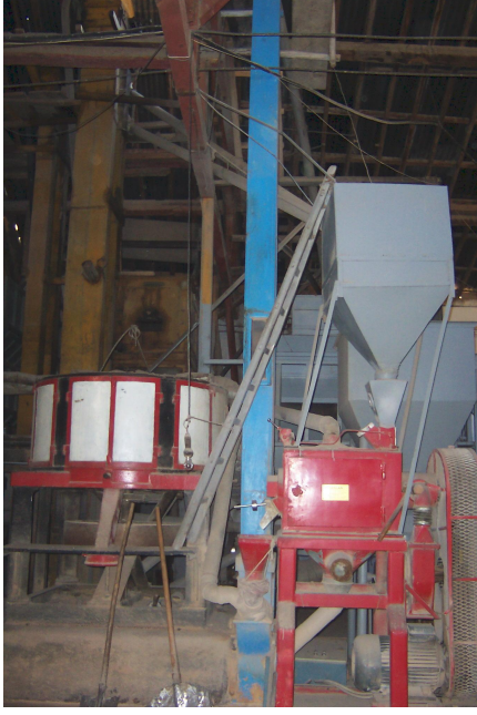
Foto Ek 1.149 Tosya, Bektaş Çeltik Fabrikası, havalı parlatma taşı ve triyör/ayırıcı, Kasım 2005
