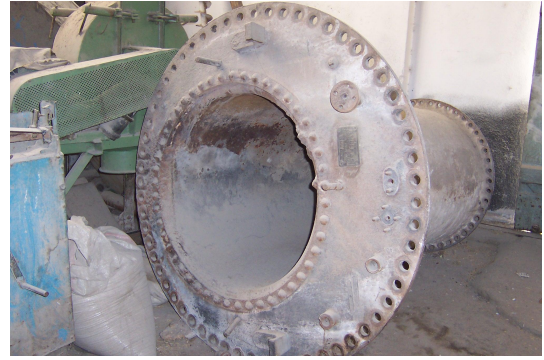
Foto Ek 1.139 Tosya, Bektaş Çeltik Fabrikası, "lokomobil" adı verilen buhar gücü üreten güç kaynağından sökülmüş bir brülör, Kasım 2005
