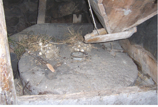
Foto Ek 1.106 Ekinören Köyü, Koca Mehmet'in Değirmeni (Şerafettin Gökçe Değirmeni), musluk ve ayar ipi ile değirmen taşı boğazı, Temmuz 2005
