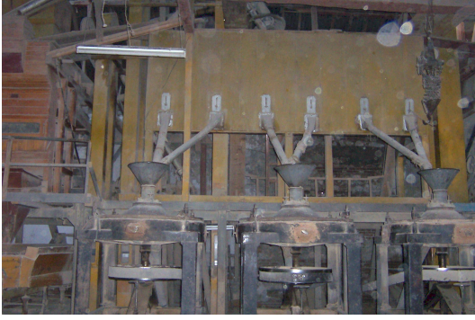
Foto Ek 1.145 Tosya, Bektaş Çeltik Fabrikası, padinden sonra gelen depo ve soyucu taşlar, Kasım 2005
