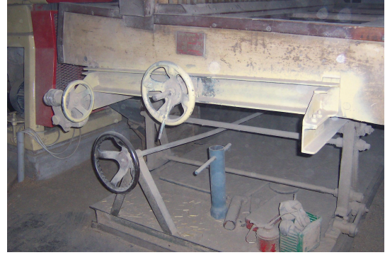
Foto Ek 1.240 Şamlılar Çeltik Fabrikası, Z-04 Üretim 1 mahallinde ayırıcı "padin" makinesi, Temmuz 2005
