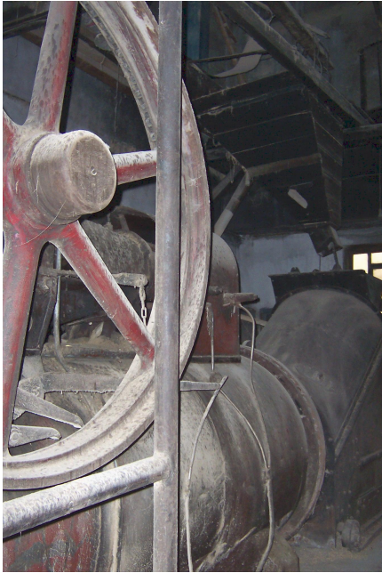
Foto Ek 1.142 Tosya, Bektaş Çeltik Fabrikası, "lokomobil" adı verilen buhar gücü üreten güç kaynağı, Kasım 2005
