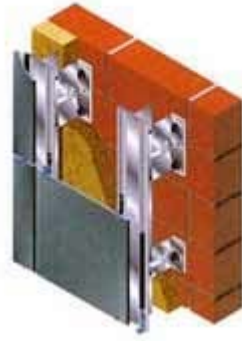
Şekil 2.36 Profilli klipsli yöntem (Eczacıbaşı, 2002)
