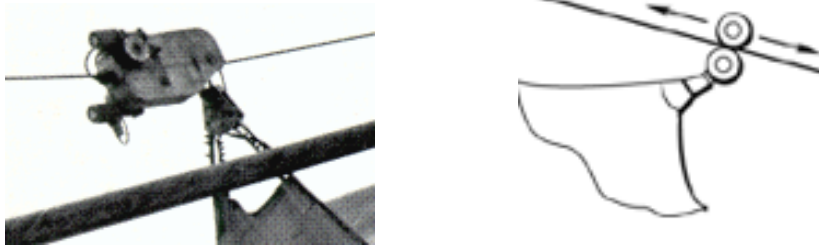
Şekil 3.37 Stadyum örtüsü'nün kayar mekanizmalı işleyişi [18]
