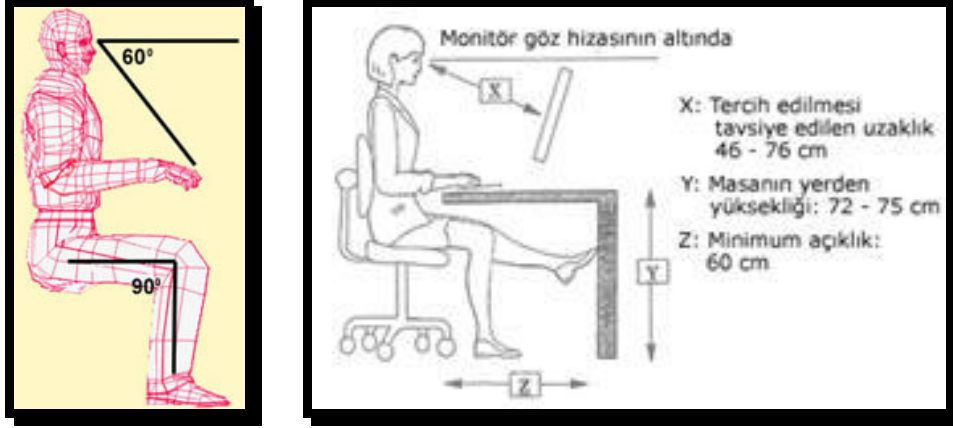
Şekil 4.23 Sağlanması gereken optimum oturuş açıları [81] Şekil 4.24 Çalışırken sağlanması gereken minimum masa altı aralıkları
