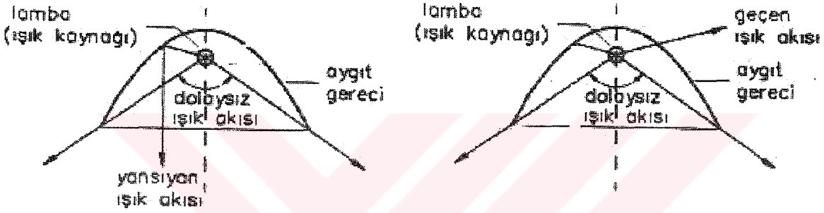
Şekil 4.1 Aydınlatma aygıtından çıkan, dolaysız ve yansıyan -geçen ışık akısı bölümleri (Öztürk, 1995)
