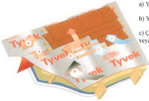
Şekil 4.38 Buhar geçirgen su yalıtım örtülerinin kullanıldığı çatılarda su buharının, rüzgarın ve yağmur suyunun hareketi (Tyvek Teknik Kılavuzu)
