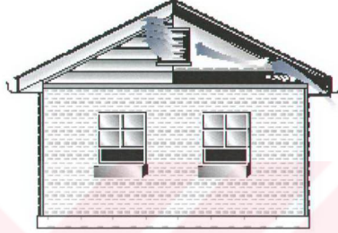
Şekil 4.13 Çatı alın penceresi ve saçaktan havalandırma [14].
