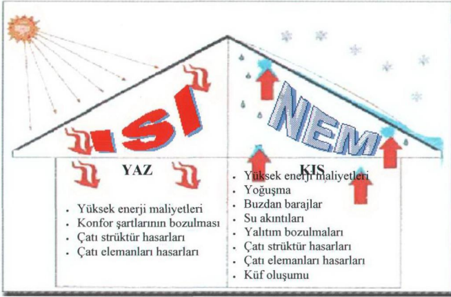
Şekil 3.4 Havalandırmasız çatılarda yazın ve kışın oluşan sorunlar [8].
