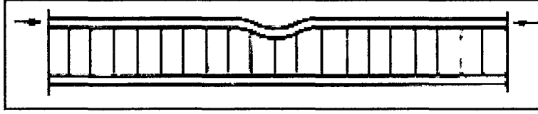
Şekil 3.4 Öz ve yüzeylerin yük altındaki buruşma dayanımı (www.msm.cam.ac.uk)
