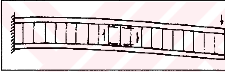
Şekil 3.2 Özün kesme kuvvetlerine dayanımı (www.msm.cam.ac.uk)
