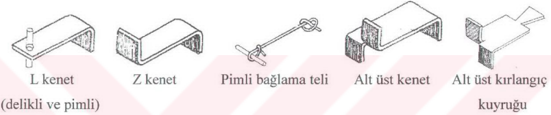
Şekil 3.26 Metal kenet türleri (Arkan, 1968)
