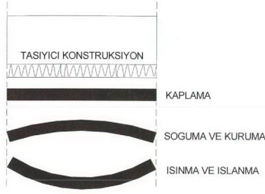
Şekil 4.7 Plak kaplamalarda ısı hareketleri ile oluşan deformasyonlar (Çorapçıođlu, 1995)
