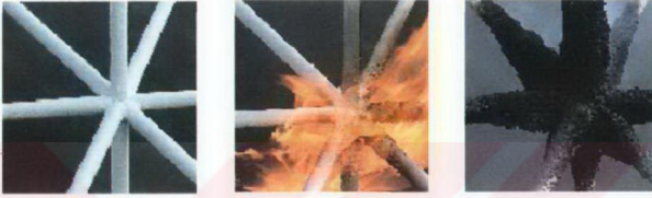
Şekil 5.19 Boyaların normal zamandaki görünümü ve yangın sonrasındaki davranışı (Unitherm ltd.) [11] .
