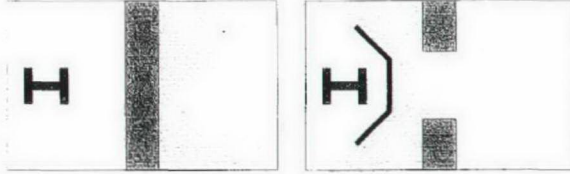
Şekil 5.29 Cephe boşluklarının karşısında konumlanan kolonların siperle korunması (Eurofer, 1991) [5].
