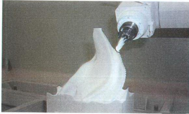
Şekil 3.2 : Bilgisayar kontrollü çok eksenli freze [16]
