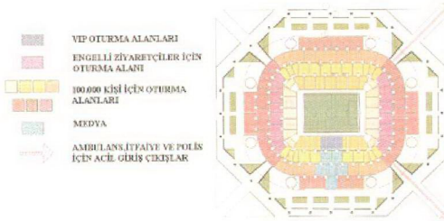
Şekil 5. 27 Seyirciler için uygun oturma alanları ve giriş-çıkışlar ( FIFA, 1995 )
