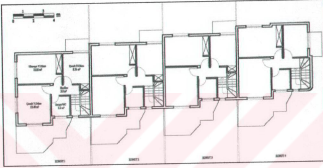
Şekil 5.3 Zig-zag sıra ev tipi birinci kat planı.
