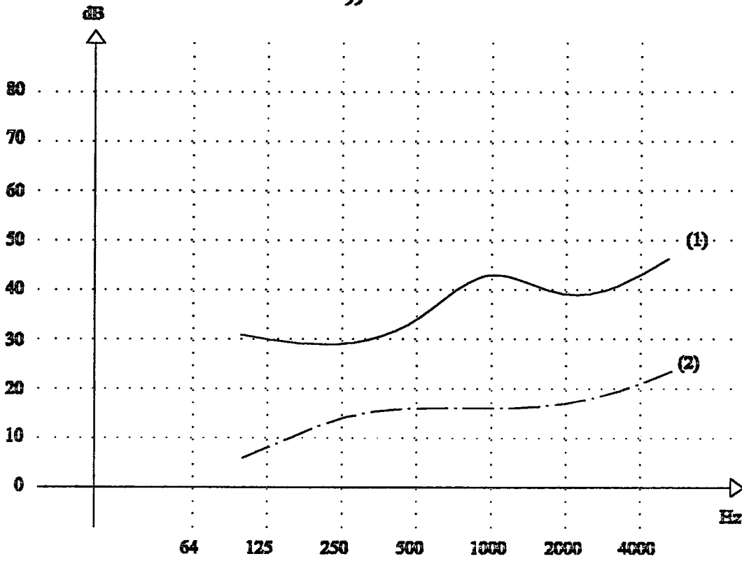
Şekil Ek-13c Mevcut giydirmce cephe ve sađlanması gereken ses geçiř kaybı grafikleri Dıř gürültü düzeyi 80 dBA (Leq) - Kabul edilebilir yapı içi gürültü düzeyi NR 50 Doluluk oranı : %100 cam (6-12-4 mm)
