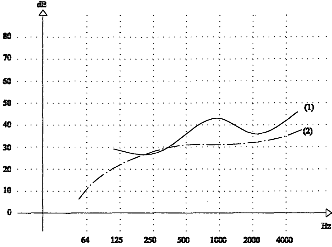
Şekil Ek-10a Mevcut giydirmiş cephe ve sağlanması gereken ses geçiş kaybı grafikleri Dış gürültü düzeyi 75 dBA (Leq) - Kabul edilebilir yapı içi gürültü düzeyi NR 30 Doluluk oranı : %100 cam (6-12-6 mm)
