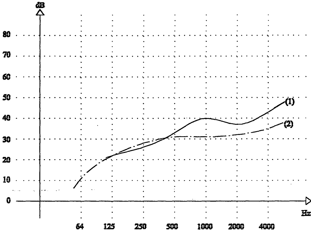
Şekil Ek-2a Mevcut giydirmce cephe ve sağlanması gereken ses geçiş kaybı grafikleri Dış gürültü düzeyi 75 dBA (Leq) - Kabul edilebilir yapı içi gürültü düzeyi NR 30 Doluluk oranı : %70 cam - %30 dolu
