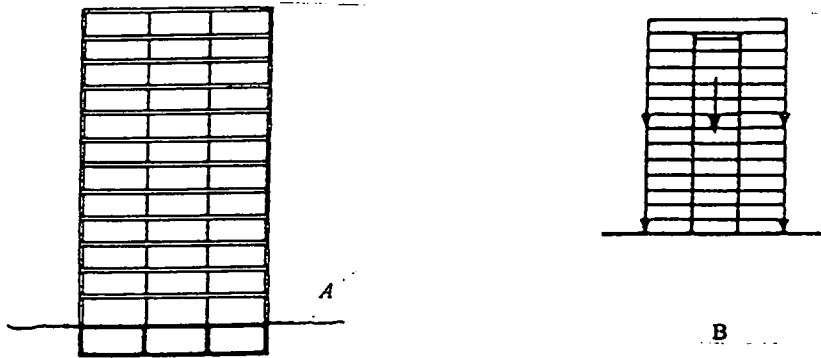
Şekil 5.24 a) Çekirdek-Dış Kolonlu Sistem b) Çekirdek-Dış Kolonlu Sistemin Zemine Yük Aktarımı (Büttner ve Hampe, 1980)
