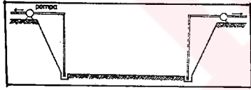
1. Yapı çukurunun açılması ve çukur- daki su sorununun çözümlenmesi
