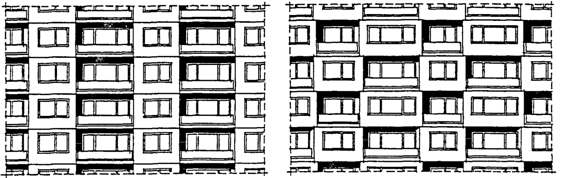
Şekil-3.48. Prefabrike Sistemle Yapılan Binalarda Cephe Örnekleri
