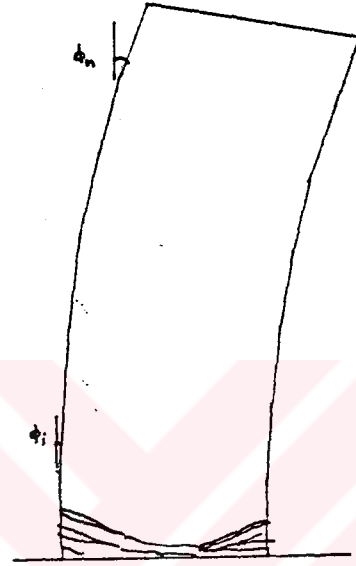
Münferit Konsol Perde Duvarın Tabanında Mafsallaşma ve Üst Katlara Doğru Artan Yatay Ötelemeler ve Dönmeler
