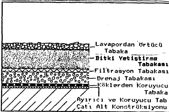
Şekil 40 - Optima Az Yoğun Çatı Bitkilendirme Sistemi
