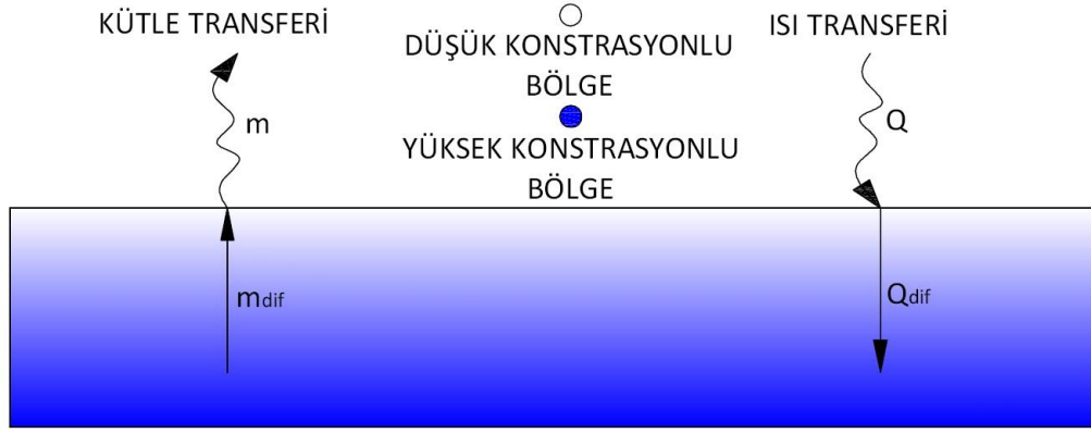
Şekil 3.1 Isı ve Kütle Transferinin Tek Yüzeyden Kurutmada Şematik Gösterimi
