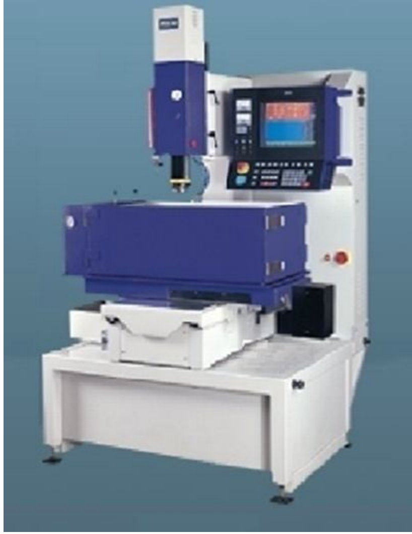
Şekil 3.4 Neu-ar marka CNC-P50 tipi elektroerozyon tezgahı
