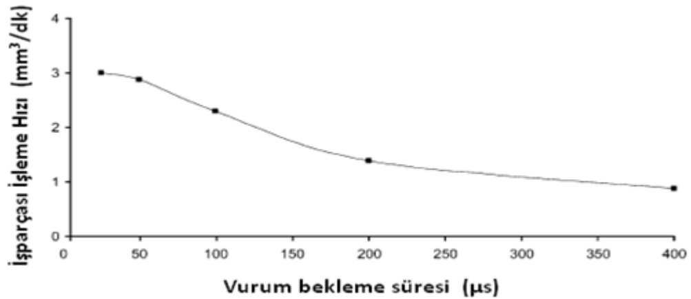
Şekil 1.4 Vurum bekleme süresinin işparçası işleme hızına etkisi [9]
