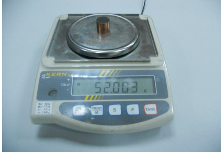
Şekil 3.5 Elektrot kütle kaybının hassas terazi ile ölçülmesi
